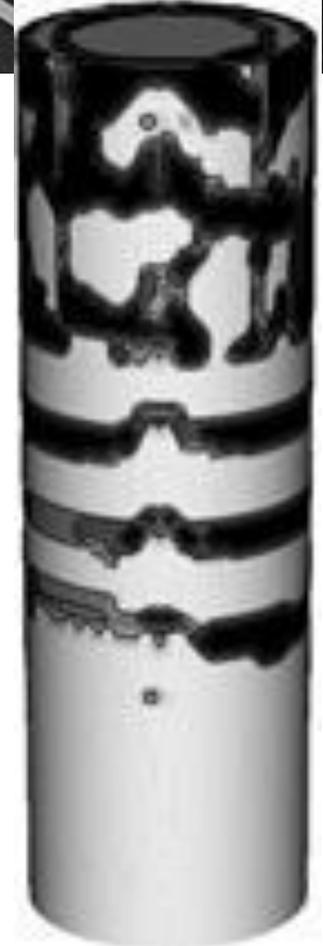
1) Отрывное и отрывно-сдвиговое разрушение керна происходит при большой разнице между главными напряжениями. Увеличение ДБР в допустимых пределах играет положительную роль и может перевести сильное разрушение в частичное. Роль НБИ может быть как отрицательной так и положительной.
