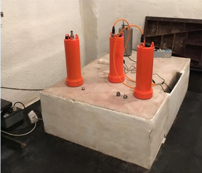
Сравнительные испытания маятниковых сейсмометров (Guralp, Streckeisen) и гео-гидроакустических модулей на основе молекулярно-электронных вертикальных велосиметров (совместная разработка «R-sensors» (МФТИ), ИФЗ РАН и АО «Концерн МПО – «Гидроприбор») на калибровочном постаменте Геофизической службы РАН (г. Обнинск).
